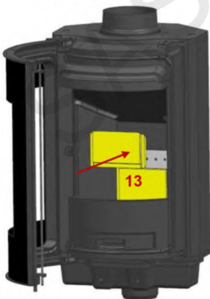
13 : Insérer le réfractaire haut à l'intérieur du corps.
